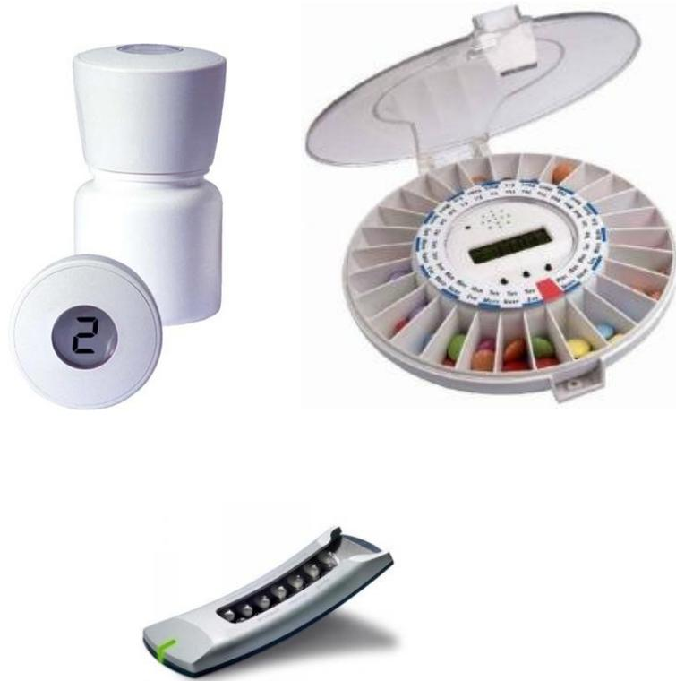
**Figure 2 :** Illustration de 3 méthodes électroniques de mesure de l'observance : flacon électronique, pilulier électronique, blister électronique (19).
